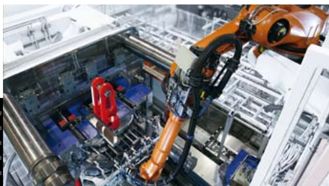
Los robots de consola KUKA resultan ideales para la retirada de piezas en máquinas de moldear por inyección.
